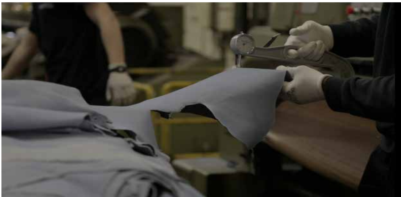
Měření tloušťky kůže po postruhování pomocí tloušťkoměru
