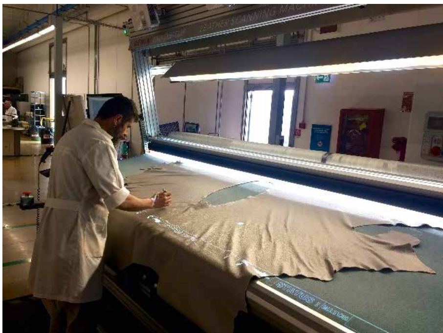
Kontrola kůže a vymezení zón kvality pomocí optického pera
